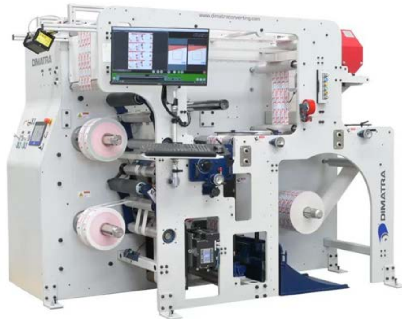
Máquina Cortadora Saneadora de Etiquetas *Aplica sistema de inspección de etiquetas autoadheribles.
